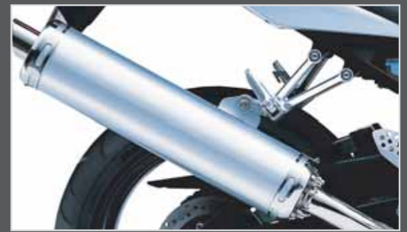
Silencioso de titanio y cuerpo exterior en aluminio
